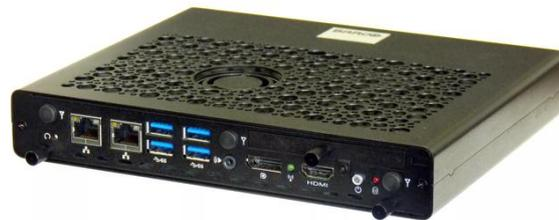
巴可公司的OpS-100 ThinClient是一个小型的显示器控制器，专为驱动更多两个HD分辨率（1920 x 1080）显示器而打造。它用于巴可公司OpSpace网络可视化和协作环境，可显示来自IP网络的编码流。它支持标准H.264、巴可公司的低延迟Video2Data (V2D)、巴可公司ProServer/虚拟网络计算 (VNC) 和远程显示协议 (RDP) 解码。
