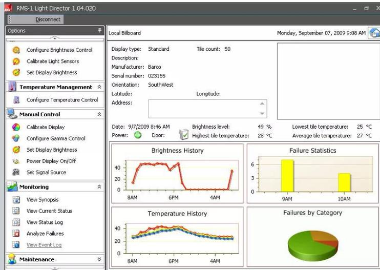
巴可公司的 RMS-1 是一款用户友好型软件，可对基于巴可 NNI 和 DVI 的 LED 显示器进行远程控制、监控和诊断。该软件与智能代理软件集成，采用直观的图像界面，使显示控制操作变得简单轻松，设置起来也非常容易。
