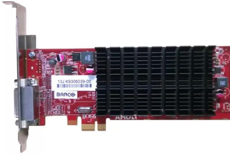
MXRT-1451是一款薄型小巧的PCIe显示器控制器，用于驱动显示分辨率高达1920 x 1200的HIS RIS以及病人列表监视器。因为它是PCIex1卡，所以可安装在所有PCIe x16槽口都被占用的工作站上。
