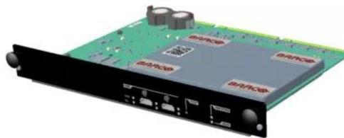
El módulo ICP-D permite el uso de servidores de medios de terceros en proyectores de cine Barco. Para obtener una lista de IMB compatibles, consulte el manual de instalación del ICP-D.
