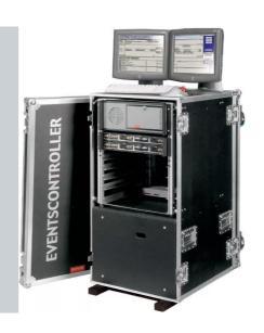
● 全集中控制全部舞台设计,例如白昼显示器、投影机、Catalyst⊠、发光设备、制烟机、图像生成器、液压系统... 支持各种控制协议: DMX512、MIDI、RS422、RS232、TCP/IP图像处理: 颜色键控、阿尔法融合、Z-向控制及其他。 全部D320 功能、逐行显示、帧速率转换。 图像与系统控制Positracking⊠ D320 多窗口显示效果演出会展控制器在坚固紧凑的空运箱中运输。 在标准配置中,包括演出会展控制器、1个D320、背面接插板和内存用户控制台便于运输。可扩展至6个D320单元。
