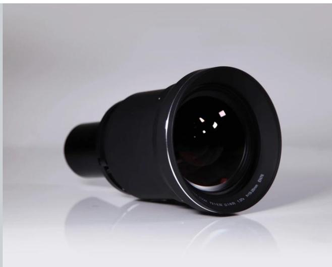
EN76レンズは、輝度を最大化し、ほこりの内部侵入を防ぐ特殊設計を備えているほか、バレルの設計を改良することで動きと振動に対する耐久性を向上させています。このレンズは、最も要求の厳しい高解像度パフォーマンスを実現するため、異なるコーティングが施された20個のガラス要素で構成されており、夜間視力と赤外線伝送に最適化されています。内部にほこりが入る原因となる、プロジェクター前面のレンズに沿った溝からの空気の流れを遮断するため、ダストシーリングも採用しています。
