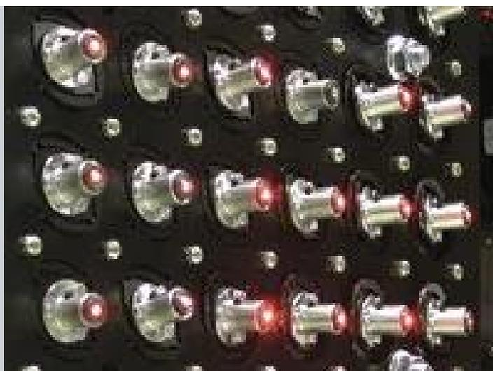
BarcoのLDAT™ はリファレンスとなるテストパターンを表示することで、各ディスプレイチャンネルを効果的に調整するのに役立ちます。LDAT™ は画面上の任意のポイントに、最大30個のレーザー光を個別に照射することができます。マルチディスプレイシステムの各チャンネルすべてに「個別の印」を表示できるように、複数のレーザーアレイを使用しています。
