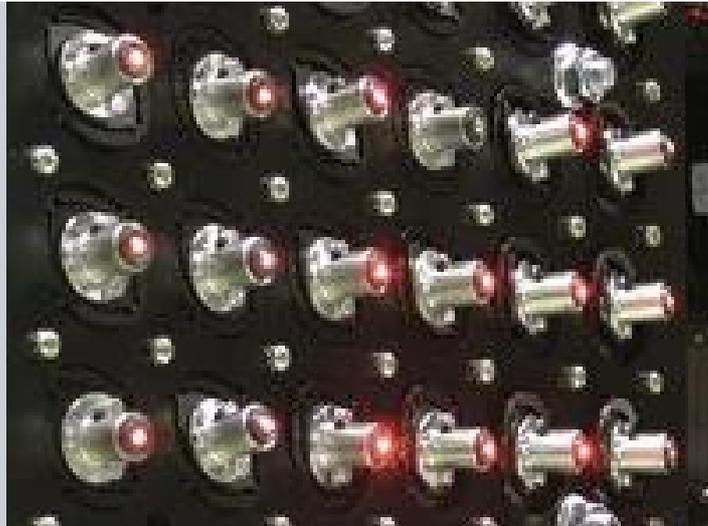
Barco 的 LDAT™ 标记参考图案以有效对齐显示通道。LDAT™ 可提供最多 30 个专用激光光源的解决方案，这些光源可独立指向屏幕上的点。使用多个阵列来标记完整的多通道系统。
