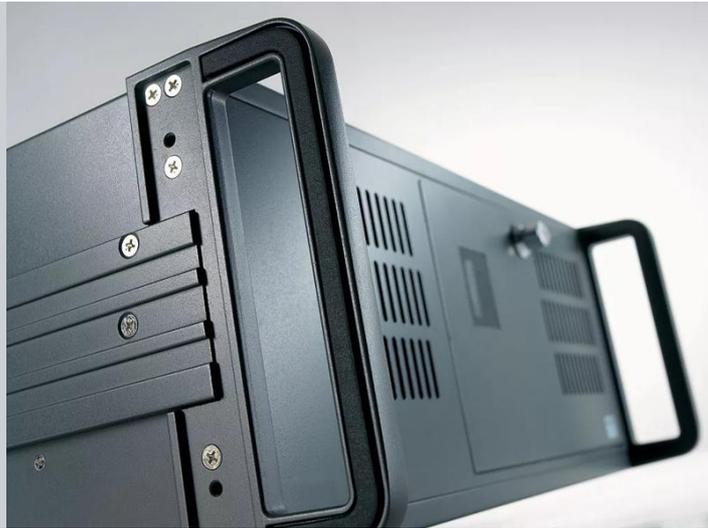
JP2K サポートのある Barco の TransForm N アウトプット・ノードは、パワフルな PC ベースのネットワーク・グラフィック・プロセッサです。ネットワーク可視化環境で使用され、ギガビット・イーサネット/IP ネットワークからのエンコードされたストリームを表示できます。デコーディング・ブロックは、MPEG-2、MPEG-4、H-264 のソフトウェア・デコーディングをサポートします。高精度 JP2K ストリームは、Barco ハードウェア・アクセラレータ・カードを通じてデコードできます。ディスプレイ・コントローラーは、ネットワークのクライアントによる要求に応じてレンダリング・オペレーションを実行するハイエンド・グラフィックカードを装備します。
