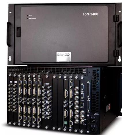
巴可公司的FSN-1400底座是FSN系列的强大核心。它是一个模块化、可现场配置的底座，可提供所有系统视频处理功能。它提供了14个卡插槽，可容纳通用的输入和输出卡、8个SDI输入和输出、双输出多查看器卡和混合效果卡。
