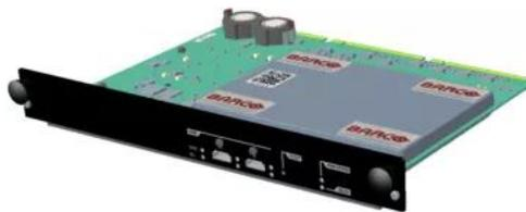
Модуль ICP-D позволяет использовать сторонние серверы мультимедиа на кинопроекторах Varco. Список поддерживаемых интегрированных медиаблоков см. в руководстве по установке ICP-D.
