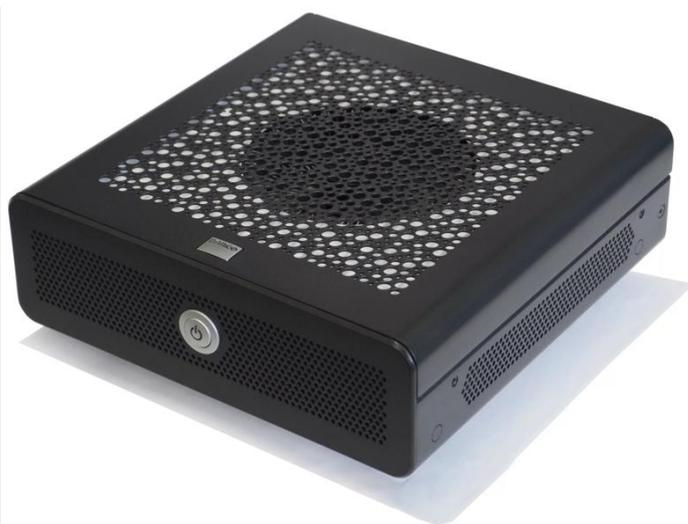
BarcoのOPS-110シンククライアントは、最大2台のディスプレイをHD解像度 (1920 x 1080) で駆動するように特別に構築された小型フォームファクタのディスプレイコントローラです。これは、Barco OpSpaceネットワーク化された視覚化およびコラボレーション環境で使用され、IPネットワークから送信されるエンコードされたストリームを表示します。標準H.264、Barcoの低遅延Video2Data (V2D)、仮想ネットワークコンピューティング (VNC)、およびリモートディスプレイプロトコル (RDP) デコードをサポートします。
