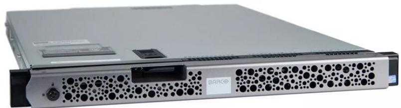
Enterprise-class Server R320-D2は、ネットワーク型のビジュアライゼーション環境で複数のタスクを処理できる、強力なコンピューティングサーバーです。卓越した性能を誇る最新のQuad-Core Intel® Xeon®プロセッサを搭載しており、クラス最高級のメディア統合機能を発揮します。Enterprise-class Server D2は、BarcoのCMSネットワーク型ソリューション用の認定プラットフォームです。
