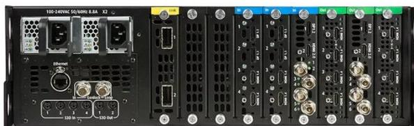
Имея 14 входов и 14 выходов, S3 Tri-combo расширяет возможности благодаря входным и выходным платам Tri-combo, поддерживающим расширение до 4K 60p по одному кабелю. Эта модель имеет такие же характеристики производительности, качества изображения, универсальности и долговечности, как и S3-4K. Единственное отличие — в большей входной и выходной емкости. In short: all the tools you need to create a stunning live experience, in a single compact and roadworthy housing.
