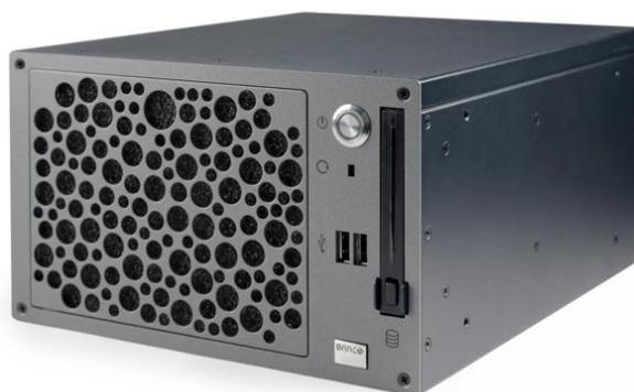
DMS是紧凑型多功能平台，执行关键的归档和流发布任务。它是第一个多流同步网络记录器和回放装置，能够同时归档许多高清视频、图形流以及音频和元数据。其第二个重要任务是流发布和网络的中继节点。在此功能中，DMS将单播流转换为多播流（反之亦然）并调节输出流的带宽，以适应协作端点的网络限制。
