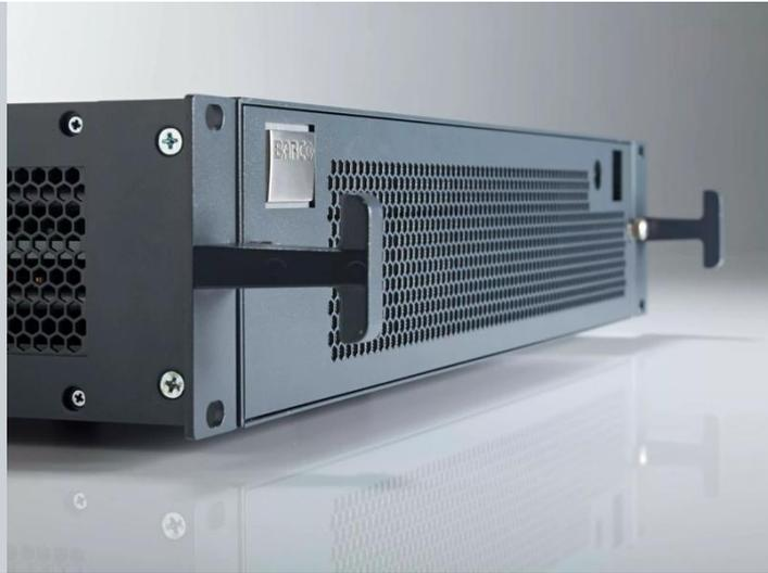
巴可公司的多通道DVI输入节点是一个独立的设备，将应用的输入信号在以太网上进行编码和传送，然后在支持JP2K解码的TransForm N输出节点上进行解码和显示。
