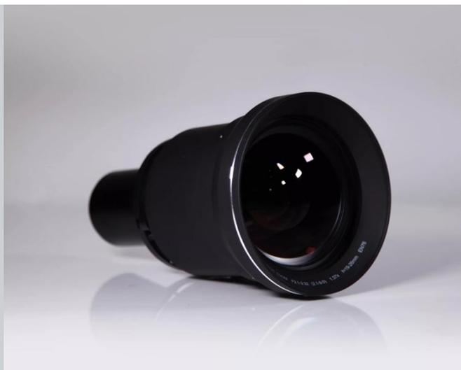
EN76 镜头经过专门设计，可最大程度地提高亮度、消除灰尘污染和通过改进的套筒设计来承受运动和振动。这种镜头由 20 个具有不同镀膜的玻璃元件组成，提供了适合严苛环境的高分辨率性能，并针对夜视和红外透射率进行了优化。此外，为了封闭多余的气流，使其穿过投影机的前部再沿着镜头穿过凹槽，还设计了防尘密封件。
