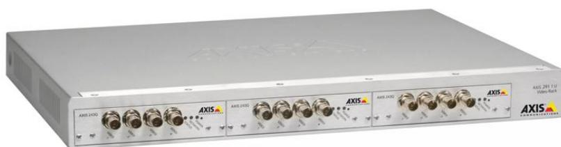
El nodo de entrada de vídeo de varios canales de Barco es un dispositivo 1U autónomo, que codifica y transmite la señal de entrada por Ethernet, para la visualización en uno o varios nodos de salida TransForm N compatibles con H.264.
