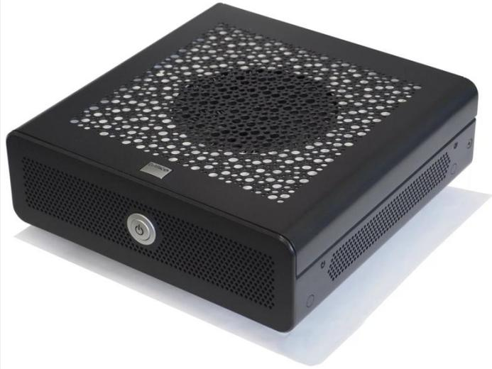
Barco의 OPS-110 썬 클라이언트는 스몰 폼 팩터 디스플레이 컨트롤러로, 특히 최대 두 대의 디스플레이를 FHD 해상도(1920 x 1080)로 구동할 수 있도록 개발되었습니다. Barco OpSpace 네트워크 시각화 및 협업 환경에서 사용되어 IP 네트워크에서 제공하는 인코딩된 스트림을 표시합니다. 이 기기는 표준 H.264, Barco의 낮은 레이턴시 Video2Data(V2D), 가상 네트워크 컴퓨팅(VNC) 및 원격 디스플레이 프로토콜(RDP) 디코딩을 지원합니다.
