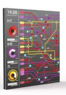
巴可OverView OVD5521是一种高性能、高亮度(700 cd/m²典型)55"LCD屏,专用于平铺式拼接显示系统。OverView OVD5521极窄的遮光板仅3.5毫米(0.14")、色彩和对比度出色、视角宽广,将高端控制室中液晶拼接显示系统的视觉表现提升到全新的高度。OverView OVD5521可以有效提高亮度,无论房间的照明条件如何,都可做到清晰可读。
