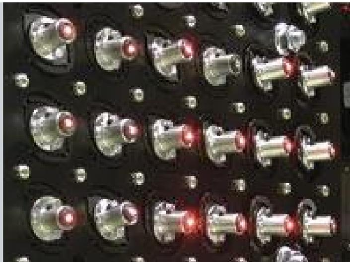
Le LDAT™ de Barco marque les modèles de référence pour aligner efficacement les canaux d'affichage. Le LDAT™ offre une solution pouvant accueillir jusqu'à 30 sources de lumière laser dédiées qui peuvent être dirigées indépendamment vers des points de l'écran. Plusieurs matrices sont utilisées pour effectuer le repérage d'un système complet multi canaux.
