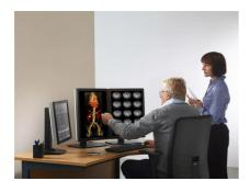
Dank der leistungsstarken LED-Hintergrundbeleuchtung benötigt das Nio Color 3MP weniger Strom, selbst bei höherer kalibrierter Leuchtdichte. Dies wirkt sich positiv auf die Wartungs- und Betriebskosten aus.
