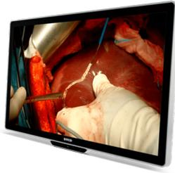
Das lüfterlose Design (SSTF-Version) und die intelligente Kabelabdeckung unterstützen die Infektionskontrolle, Desinfektion und Reinigung. Das MDSC-8532 ist für den Einsatz in der Nähe von Patient/-innen zugelassen und verfügt über eine automatisierte Failover-Methode.
