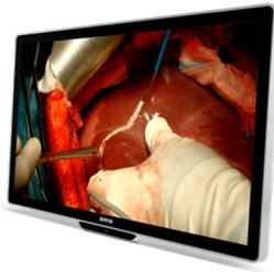
El diseño sin ventilador (versión SSTF M2) y la cubierta inteligente de los cables favorecen el control de infecciones, la desinfección y la limpieza. La MDSC-8532 está aprobada para su uso cerca de los pacientes e incluye un método de conmutación por error automatizado.
