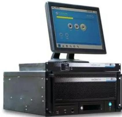
Der CineStore SoloG3 ist ein Digitalkino-Server, der im Hinblick auf DCI-Konformität konstruiert wurde. Über eine CineLink™-Verbindung lässt er sich mit jedem beliebigen DLP-Cinema™-Projektor kombinieren. Der CineStore SoloG3 ist in der Lage, Inhalte über eine herkömmliche tragbare Festplatte, die per e-SATA oder USB 2.0 angeschlossen ist, sowie über ein CRU-Medienlaufwerk zu empfangen.
